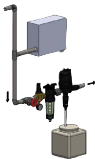
Instalación de alimentación de tanque
