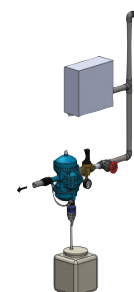
Instalación de alimentación de tanque
